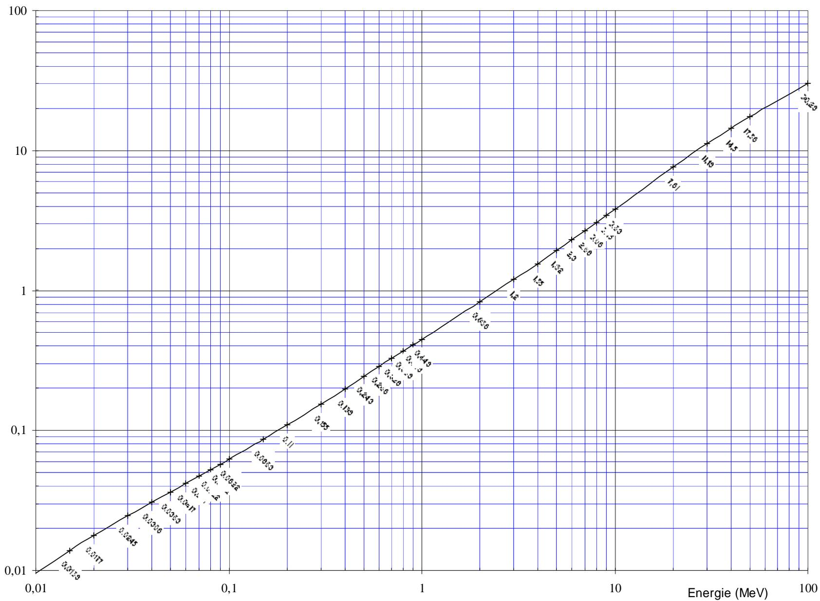
Rendement de freinage des électrons (Rf %)
