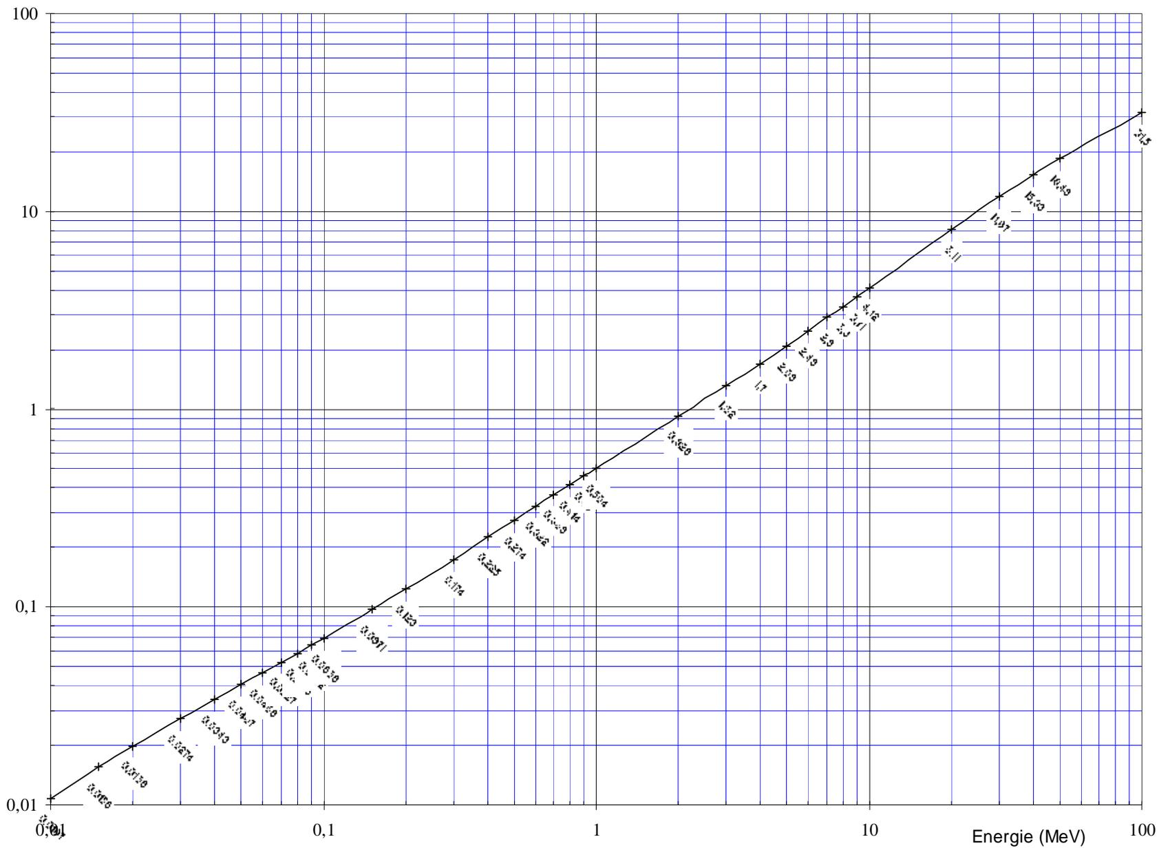
Rendement de freinage des électrons (Rf %)
