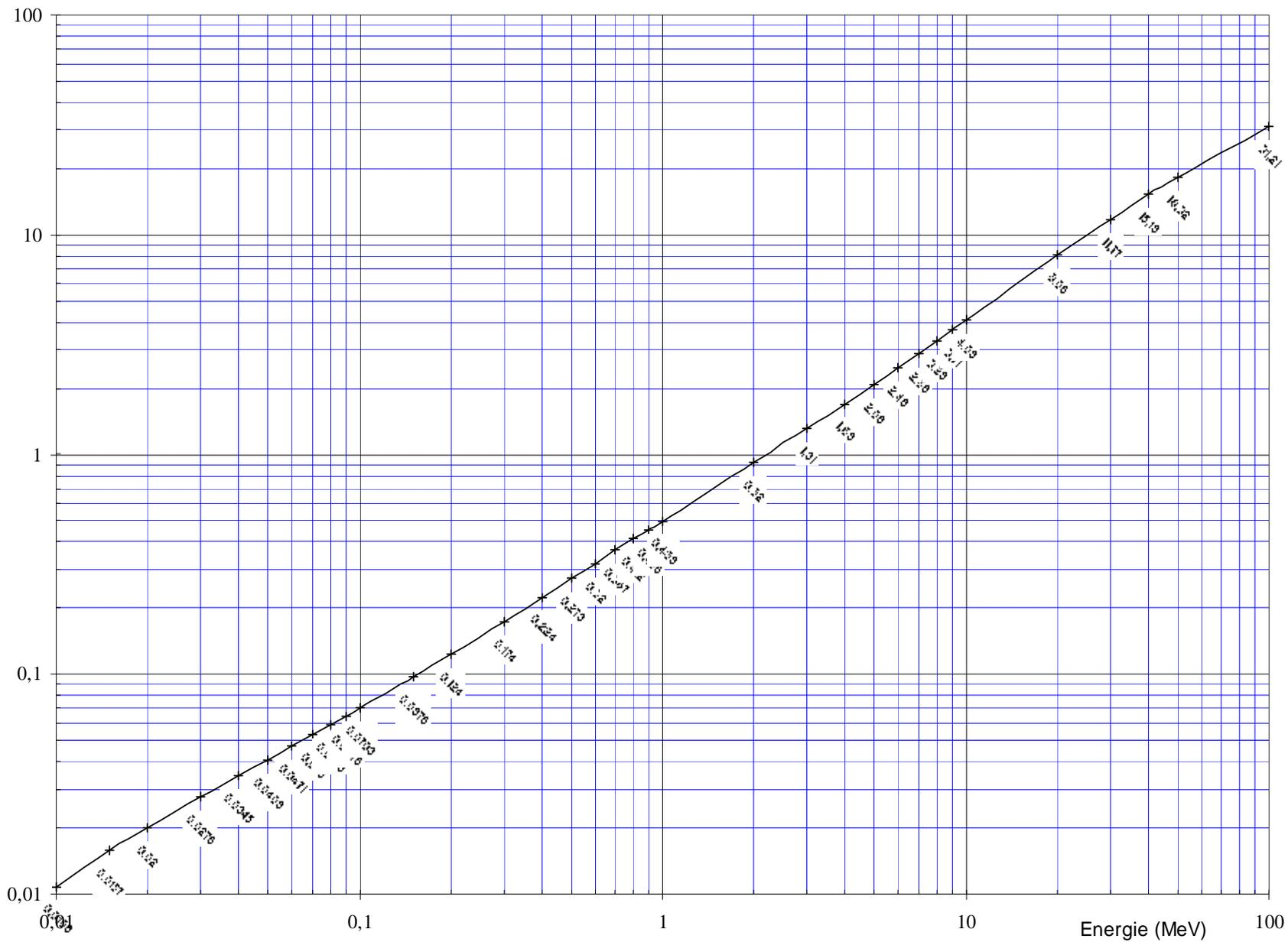
Rendement de freinage des électrons (Rf %)
