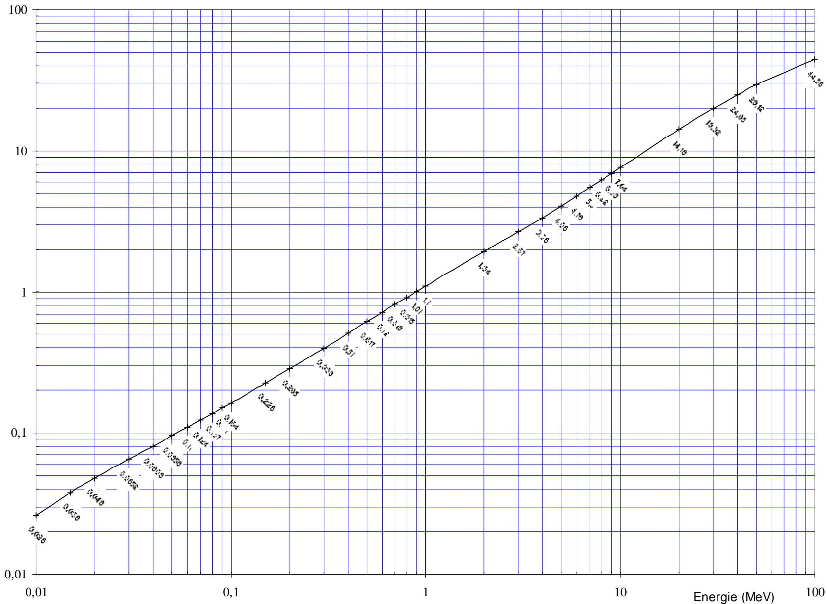
Rendement de freinage des électrons (Rf %)
