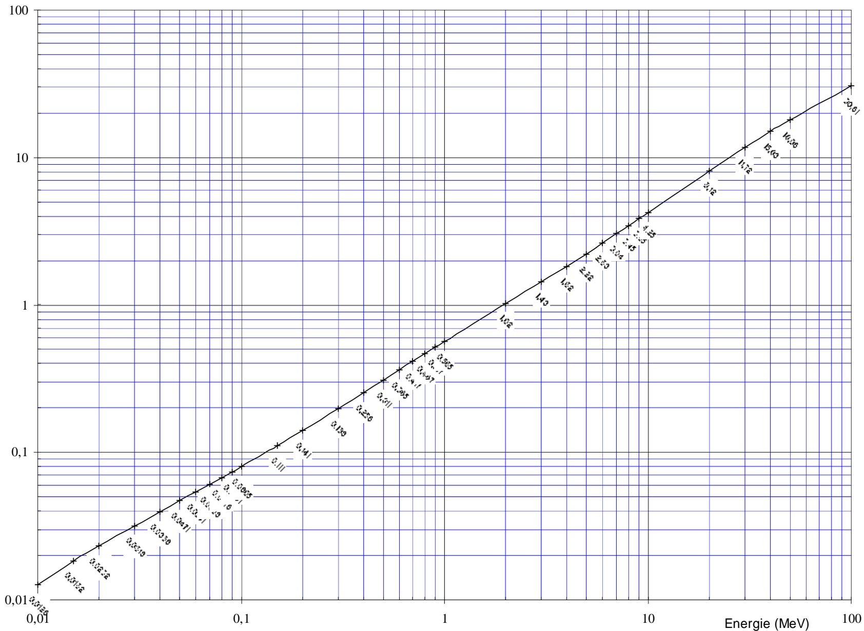
Rendement de freinage des électrons (Rf %)
